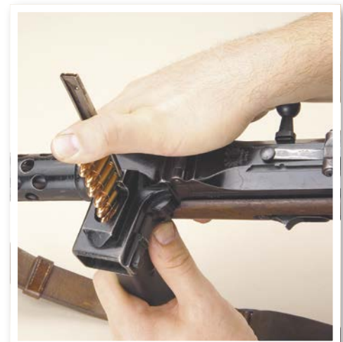
Füllen des Magazins bei der MP 34. Das Magazin wird über Ladestreifen geladen. Am Magazinschacht ist eine Ladestation eingebaut. Das Magazin wird von unten bis zum Einrasten eingeführt, dann der Ladestreifen eingesetzt und durch Daumendruck entleert. Das Magazin lässt sich einfach wieder entnehmen.
