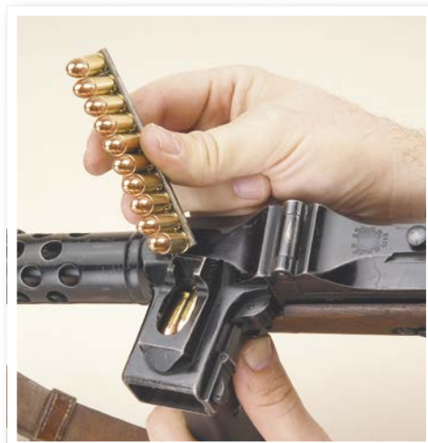
Füllen des Magazins bei der MP 34. Das Magazin wird über Ladestreifen geladen. Am Magazinschacht ist eine Ladestation eingebaut. Das Magazin wird von unten bis zum Einrasten eingeführt, dann der Ladestreifen eingesetzt und durch Daumendruck entleert. Das Magazin lässt sich einfach wieder entnehmen.
